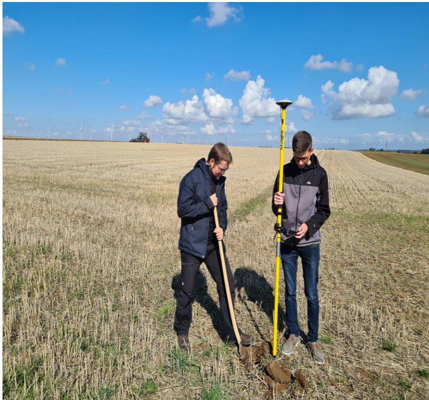
Abbildung 3: Aufsuchen einer Drainageleitung in der Örtlichkeit mittels einer GNSS Lösung (Quelle: Kreis Euskirchen)
