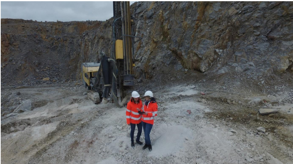
Abbildung 1: Durchführung einer Sprenganmeldung auf dem Bohrfeld mit Hilfe des GPS-Signals vom Tablet (Quelle: Hochsauerlandkreis)
