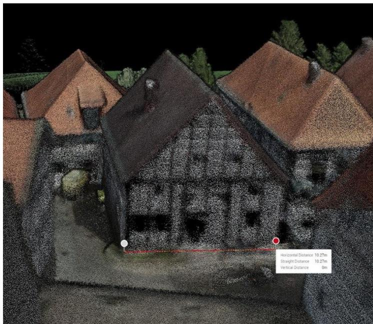
Abbildung 3: Ausschnitt Lidar-Punktwolke mit Distanzmessung (Quelle: Kreis Lippe)
