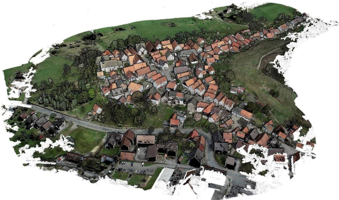
Abbildung 1: Lidar-Punktwolke (Quelle: Kreis Lippe)
